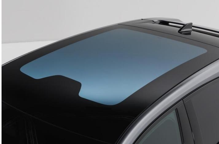
Şoferul şi pasagerii pot alege între patru poziţii ale plafonului: complet transparent, complet opac, transparent faţă şi spate opac sau invers. Cu tehnologia sa laminată multistrat, acoperişul Solarbay minimizează, de asemenea, efectele de "seră" şi de "frigider". Când şoferul opreşte contactul şi părăseşte maşina, geamul se estompează automat. La pornire, plafonul revine la ultima setare.
